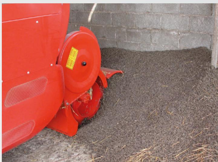
Rulo desensilador diametro 400 mm alimentado por 1 motor hidráulico de potencia 100 KW, equipados de un elevado numero de lamas y geometria diversa para una maxima eficiencia incluso en la recoleccion de productos a granel en el suelo como harinas, forrajes y otros integradores.
